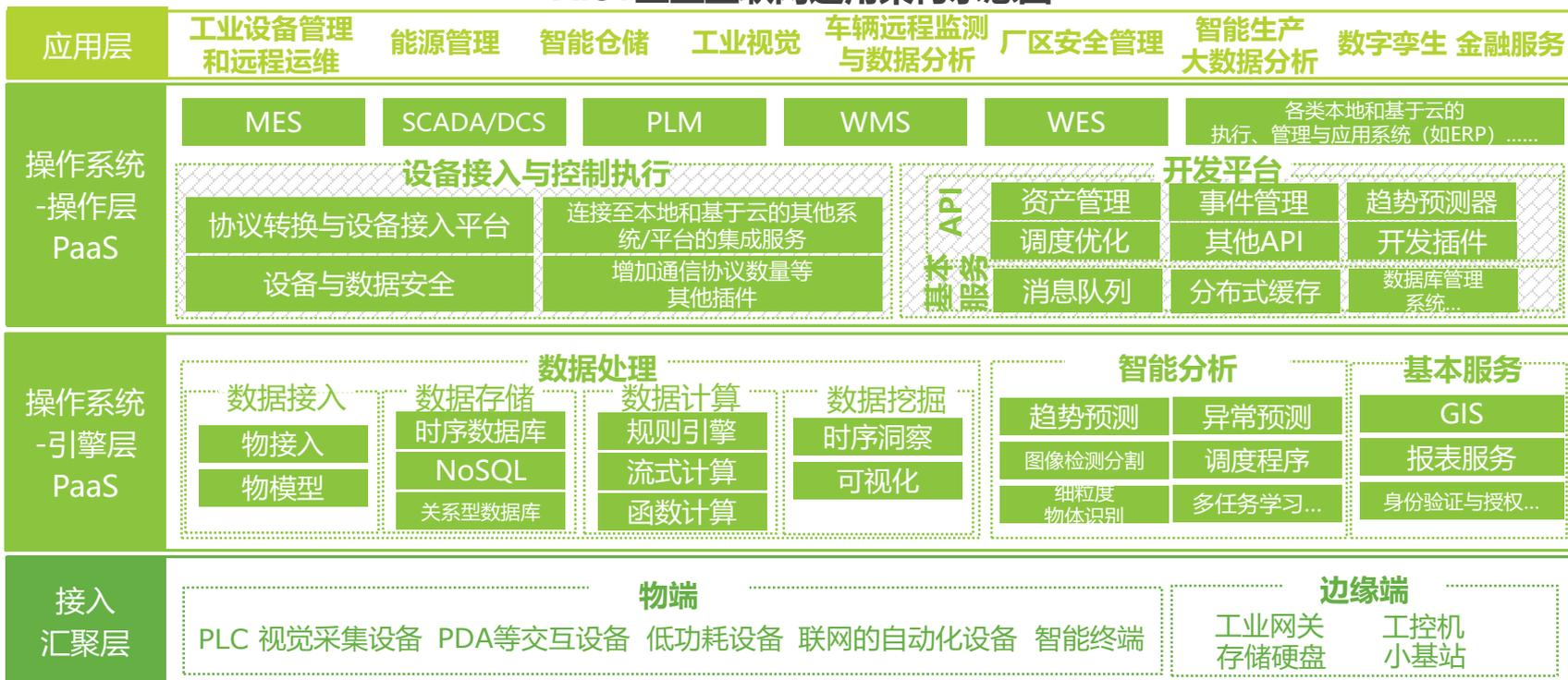
注释：不同使用场景下的AIoT架构有所不同，上图仅为一种糅合了多种场景架构的示意。
