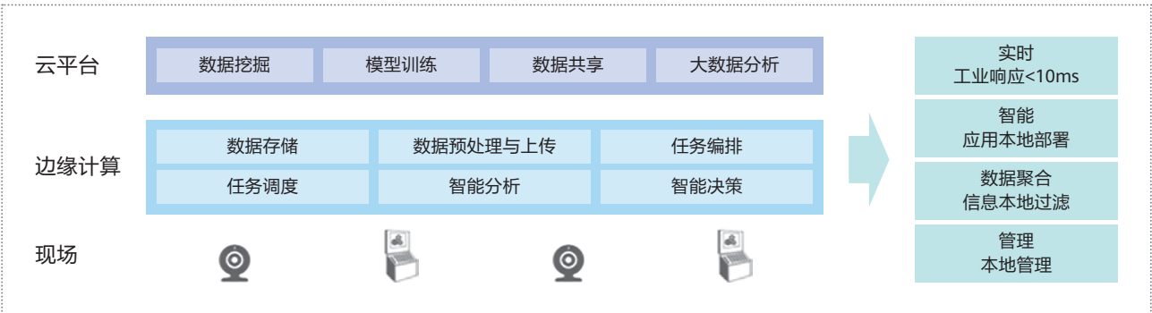
图 10 设备实时智能检测架构
