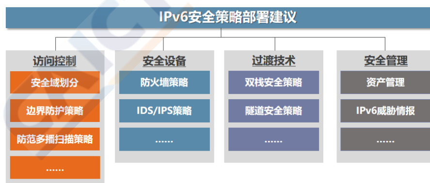
图 2.8 中国电信 IPv6 安全策略部署建议
