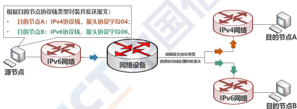
图 3.1 双栈机制原理
