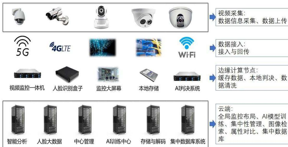
图 10 智能安防系统云边协同应用示意图
